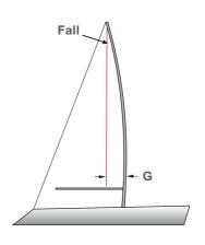
BEVOR SIE DIE MESSUNGEN AM MAST DURCHFÜHREN, SPANNEN SIE DIE ACHTER UND BACKSTAGE AN. DEN MAST FÜR NORMALE SEGELBEDINGUNGEN BIEGEN. DAS ENTSPRICHT ETWA 60% VOM MAXIMUM. BELEGEN SIE DAS HAUPTFALLENDE AM LÜMMELBESCHLAG. NEHMEN SIE DAS HAUPTFALL MÄSSIG DICHT. DARAUS ERGIBT SICH EINE GERADE REFERENZLINIE.
